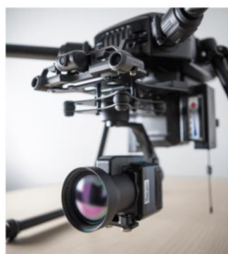
Рис. 6. Тепловизионная камера на квадрокоптере.
