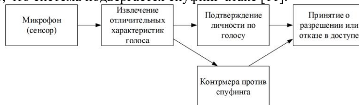
Рис. 1. Общая схема системы голосовой аутентификации
