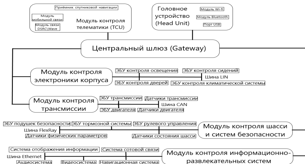
Рис. 1. Структура информационной сети транспортного средства
