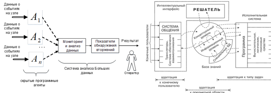
Рис. 1. Концептуальная модель обработки Больших данных, которая основана на использовании входных данных о распределенной информационной системе и ее уязвимостях, зависимостях сервисов
