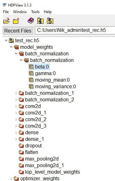
Рис. 1. Структура весов обучающей сверточной нейронной сети
