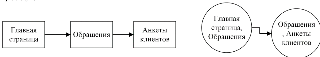
Рис. 2. Преобразование последовательности лог-записей в граф де Брюина второго порядка
