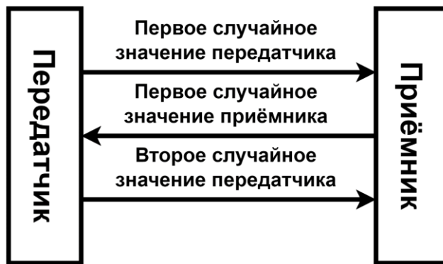
Рисунок 2 – Последовательность процедуры деривации ключей при установлении связи между устройствами
